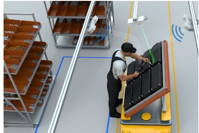
Bewegliche Werkstücke in der Fließproduktion werden vom Local Positioning System referenziert.
