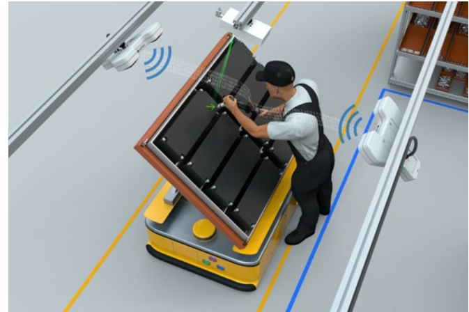
Verschraubung eines Batteriemoduls in einem bestimmten Winkel
