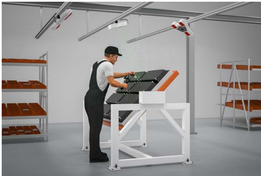
Atornillado de módulos de baterías en cualquier ángulo
