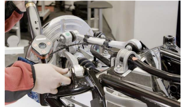
Aseguramiento de la calidad del ajuste del eje mediante el control y la documentación de la posición de la llave dinamométrica. | BMW AG
