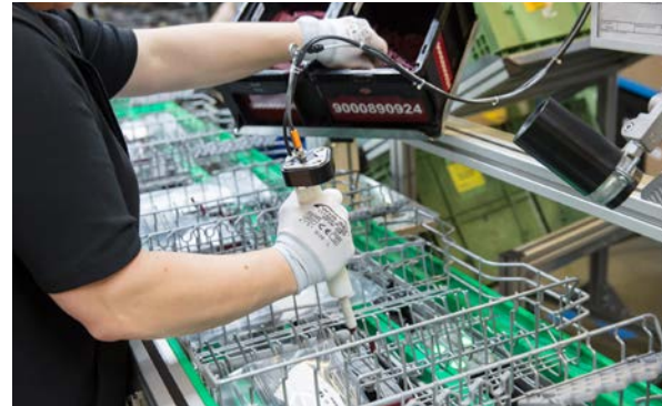
Detección de la posición de una herramienta especial en BSH Dillingen - Fijación de tapones en la cesta del lavavajillas
