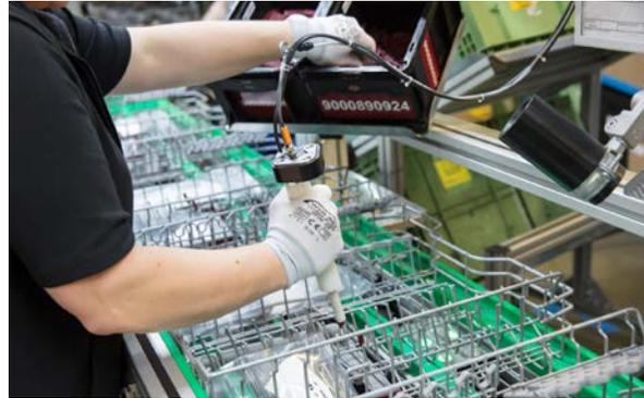
Positionserkennung eines Spezialwerkzeugs bei BSH Dillingen – Anbringen von Steckkappen im Spülmaschinenkorb
