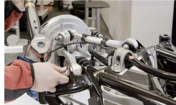
Qualitätssicherung der Achsverschraubung durch Überwachung und Dokumentation der Position des Drehmomentschlüssels | BMW AG
