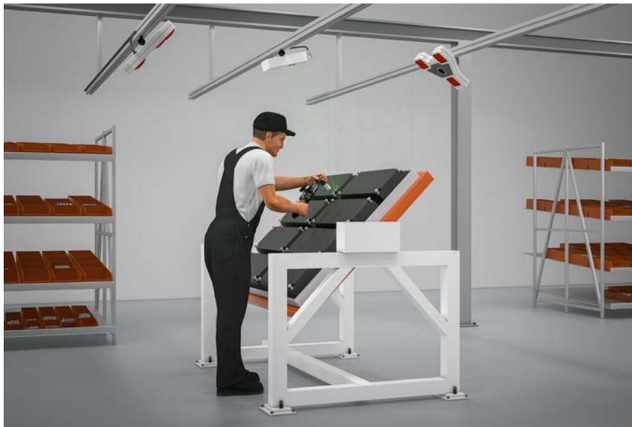
Verschraubung von Batteriemodulen in beliebigen Lagen
