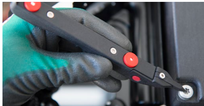
Las posiciones se programan directamente con la herramienta, o usando el puntero de posición
